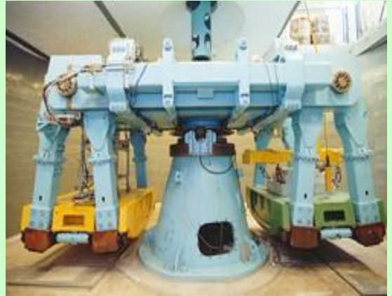
The 400 g-ton Geotechnical Centrifuge 400 g-噸岩土離心模型試驗機
