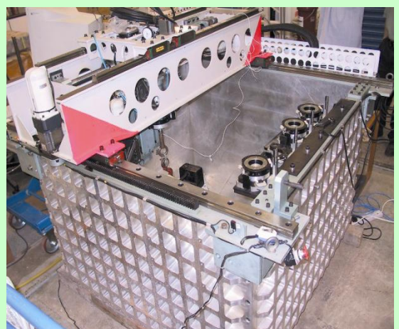
In-flight 4-Axis Robotic Manipulator 離心機四軸機
