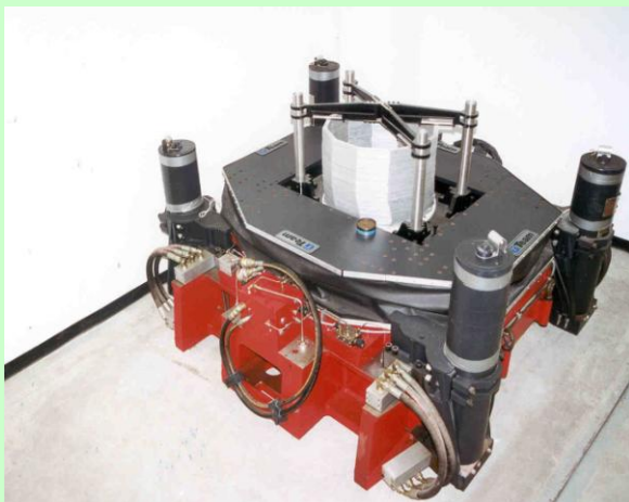
In-flight 2D Shaking Table 離心機雙向振動台
